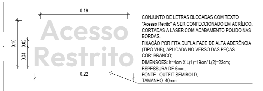
05 DETALHAMENTO PLACA DE SINALIZAÇÃO escala : 1/5
