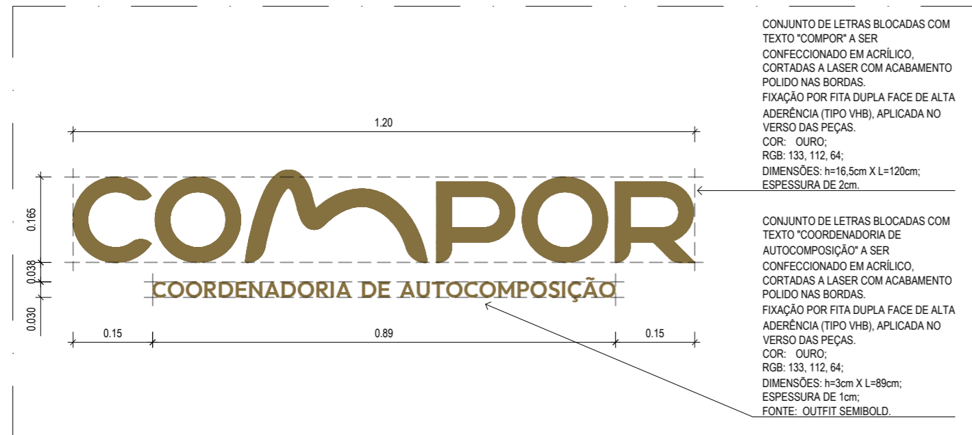
02 DETALHAMENTO | LETREIRO 1 escala : 1/10
