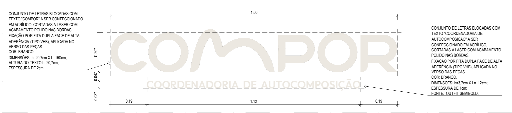
03 DETALHAMENTO | LETREIRO 2 E 3 escala : 1/10
